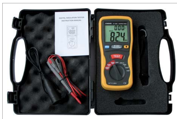
Fot. 2 Miernik rezystancji izolacji ST-5500 z wyposażeniem
